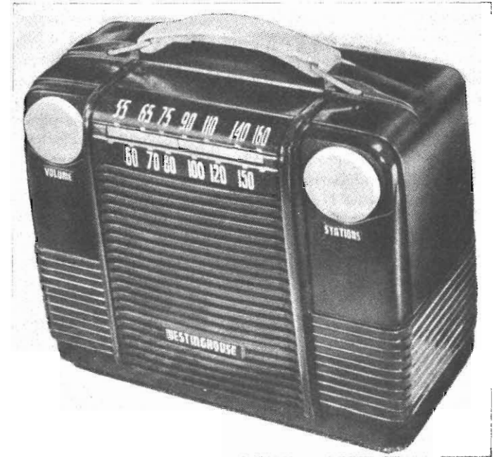
Fig. 9.13. - Tipico esempio di portatili pile-rete (a tre correnti), con rettificatore a selenio, di produzione americana. (Westinghouse mod. 185).
