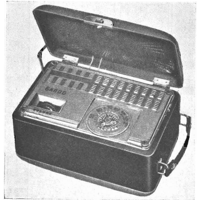
Fig. 7.4. - Portatile miniatura di produzione americana. (Garod, mod. 4A1). Lo schema è quello di fig. 7.6.
